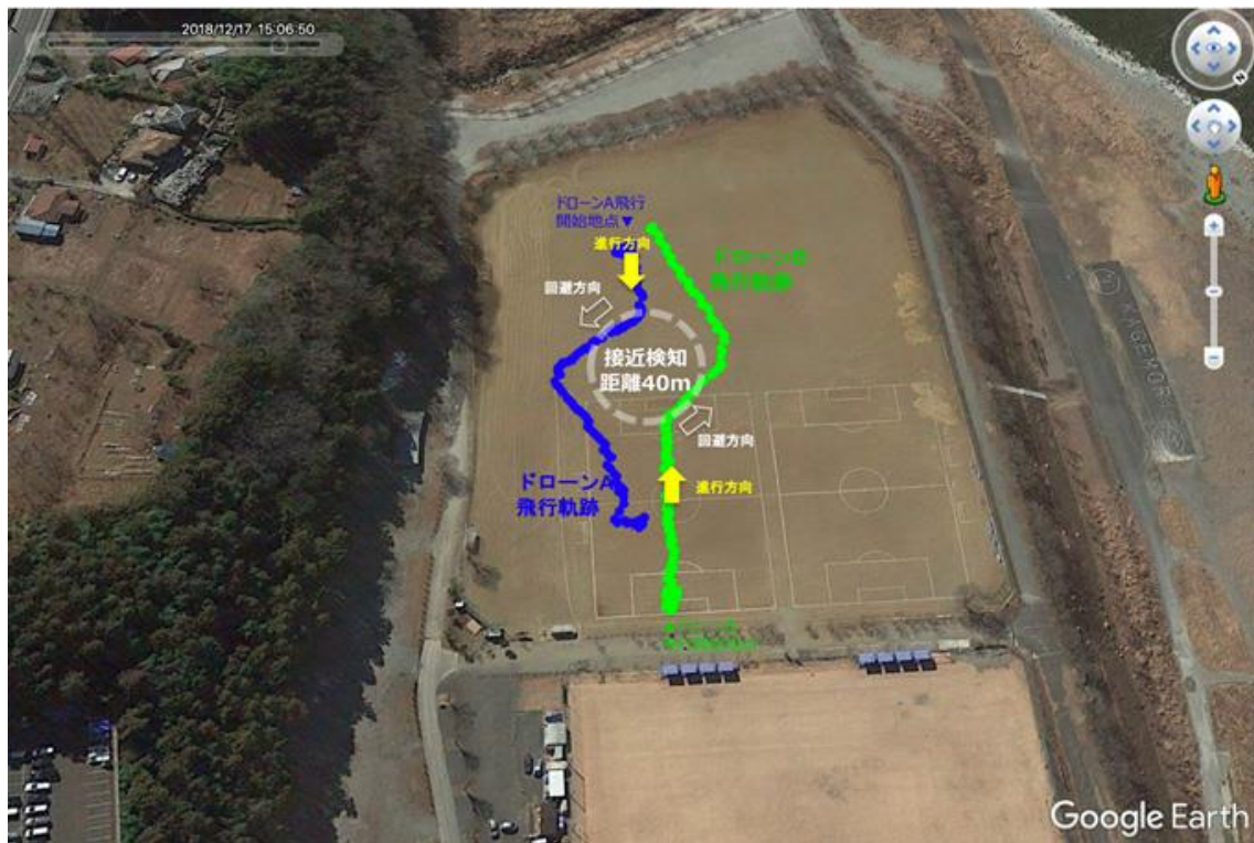
図4 1対1の回避飛行の軌跡（ドローンマッパーで取得済みの位置情報）
