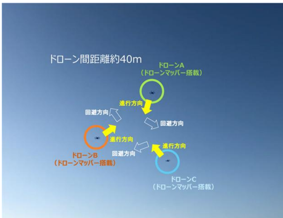
図2 飛行制御試験時の様子（3機のドローンによるニアミス回避飛行の場合）
