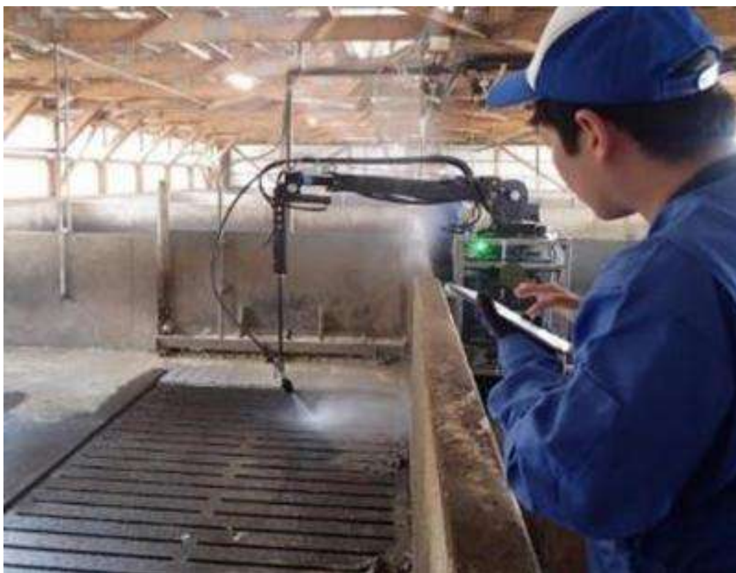
洗浄ロボット(高機能型)の洗浄様子
