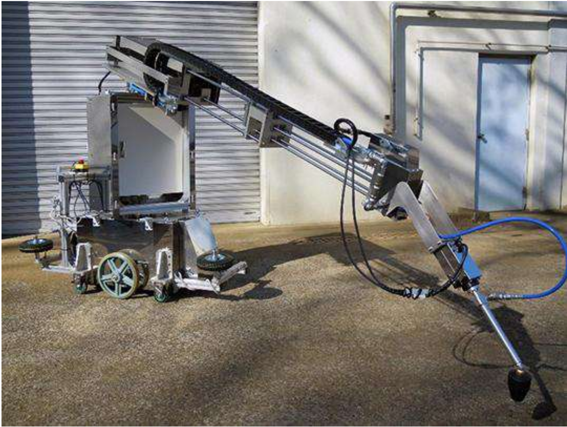
図4 肥育豚舎用洗浄ロボット(低価格型)
