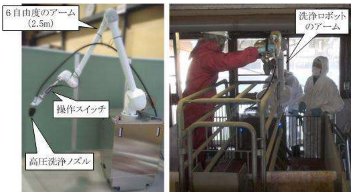
図5 開発した分娩豚舎用洗浄ロボット
