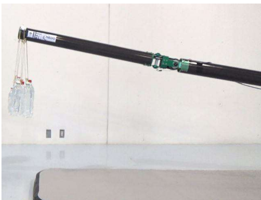
図 1. アーム手先で 10 kg の水平方向保持を実証
