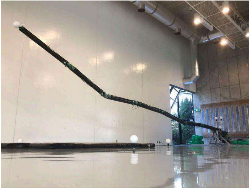
図 2. 超長尺多関節ロボットアームの全体アーム全長 10 m、直径 20 cm、重量 300 kg（アーム部 50 kg、基部 250 kg）
