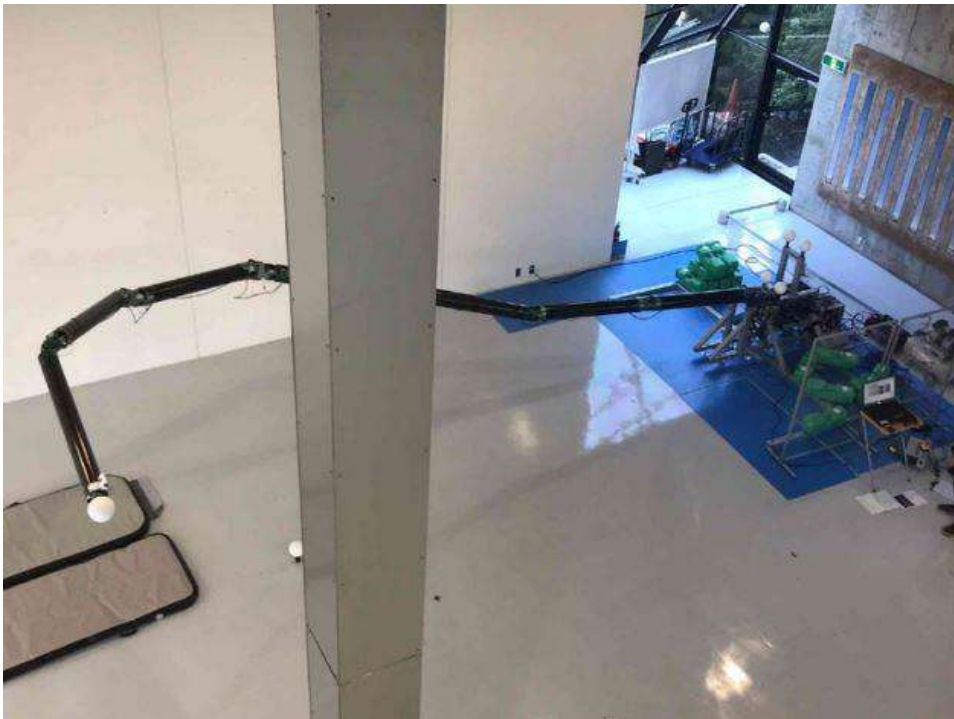
図 3. 超長尺多関節ロボットアームの横スペースへの屈曲
