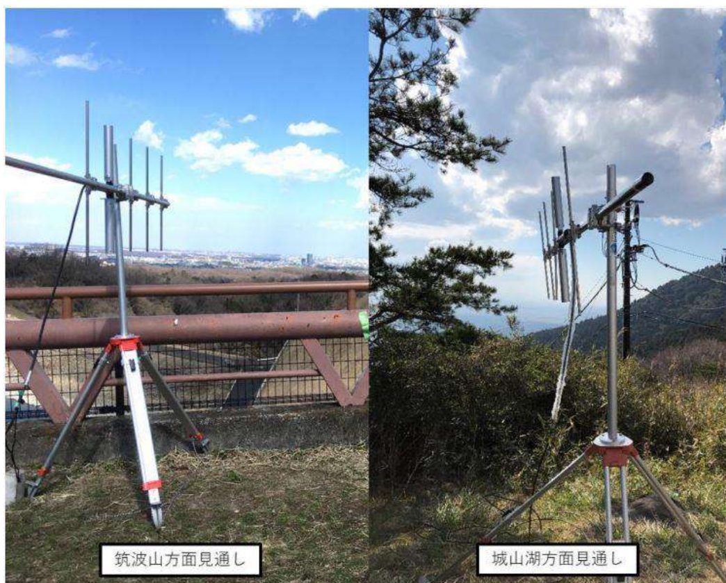
図 2 : 筑波山と城山湖に設置されたアンテナ。両アンテナ間は直線距離で 102 km の見通し環境。
