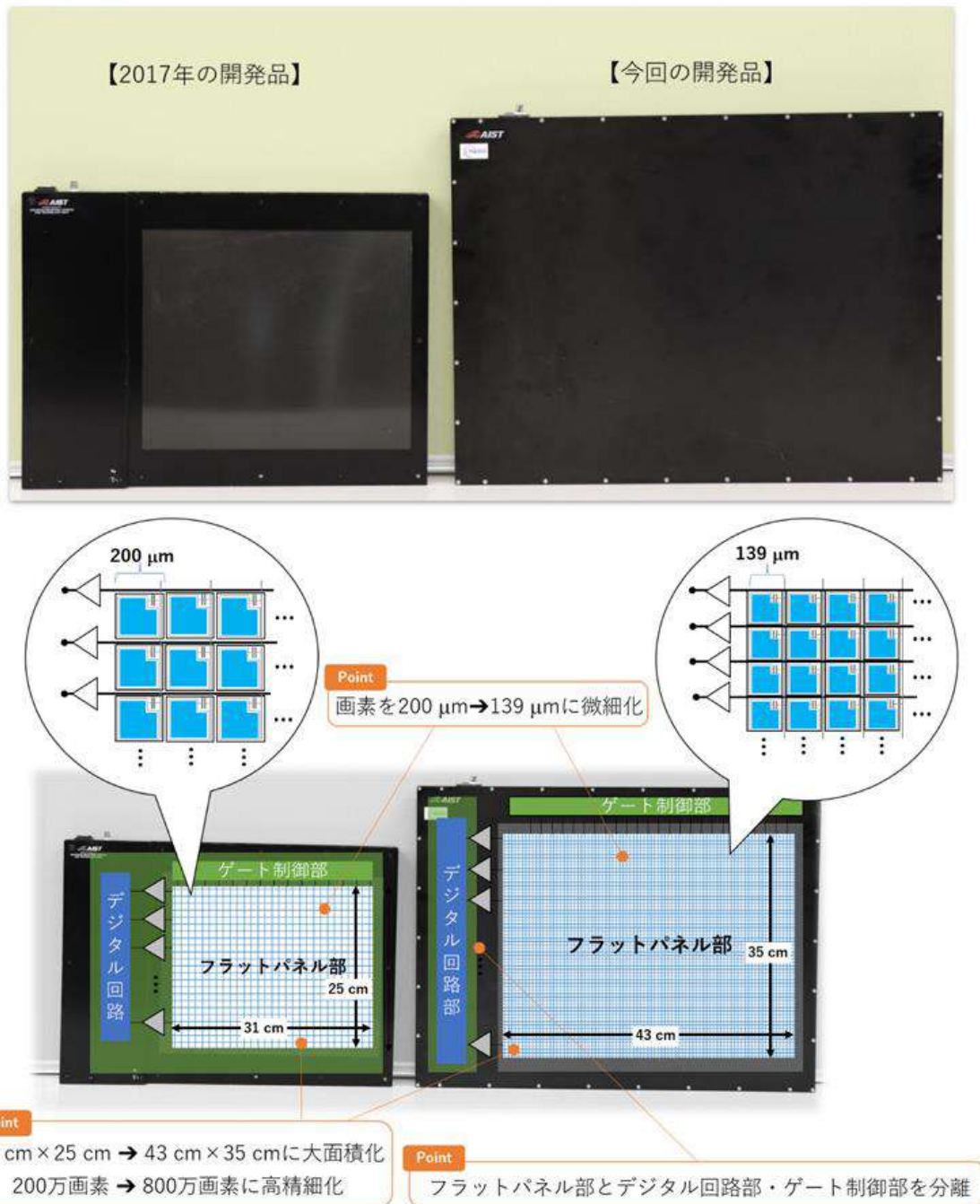
図1 2017年に開発したX線イメージング装置（左）と今回開発したX線イメージング装置（右）の外観（上）とフラットパネル部の比較（下）
