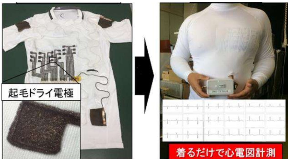
図1 着るだけで心電図を計測できるスマートウェア
