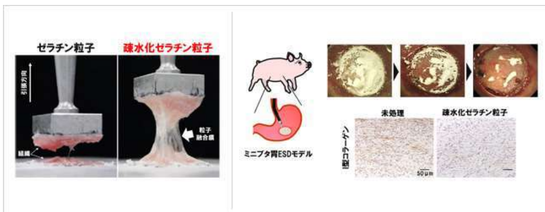
図 1: (左) 接着試験の様子。(右) ミニブタ胃 ESD モデルを用いた治癒効果の検証。
