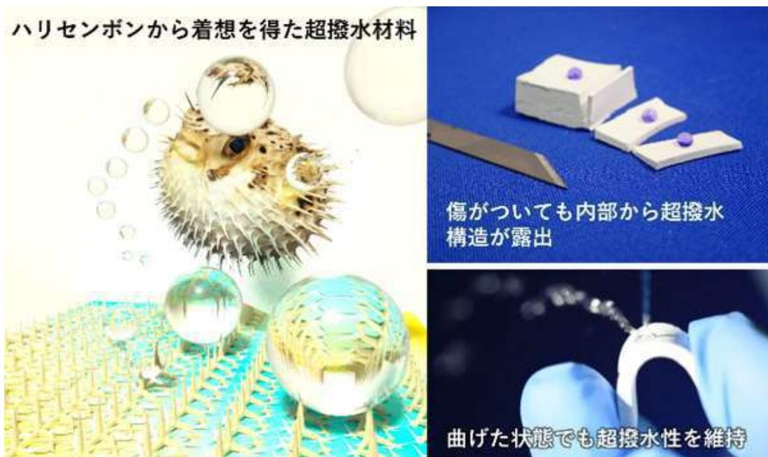
材料表面が水滴を弾く超撥水性は、水滴付着に由来する汚れや凍結、腐食、菌の繁殖を解決する手法として注目されています。超撥水性を発現させるためにはナノ・マイクロメートルスケールの微細な凹凸構造が必要ですが、擦る、捻る、引っ掻くといった外力が加わると、容易に壊れてしまい、直ちに機能が損なわれてしまうという問題がありました。
