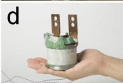
図2 超電導磁石内部のコイル構成とレアアース系高温超電導最内層コイルの製作風景・ 外観
