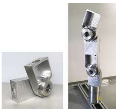
図2 アクチュエータモジュールとそれらを連結したロボットアーム
