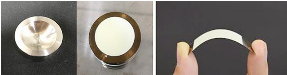
図1 作製した凹形状に加工した基材への圧電膜塗布とフレキシブル・薄型圧電膜デバイス
