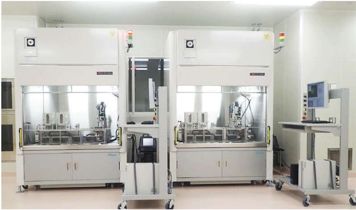
図3 J-TECのクリーンルーム内に設置した臨床用バイオ3Dプリンタ(澁谷工業とサイフューズの共同開発)
