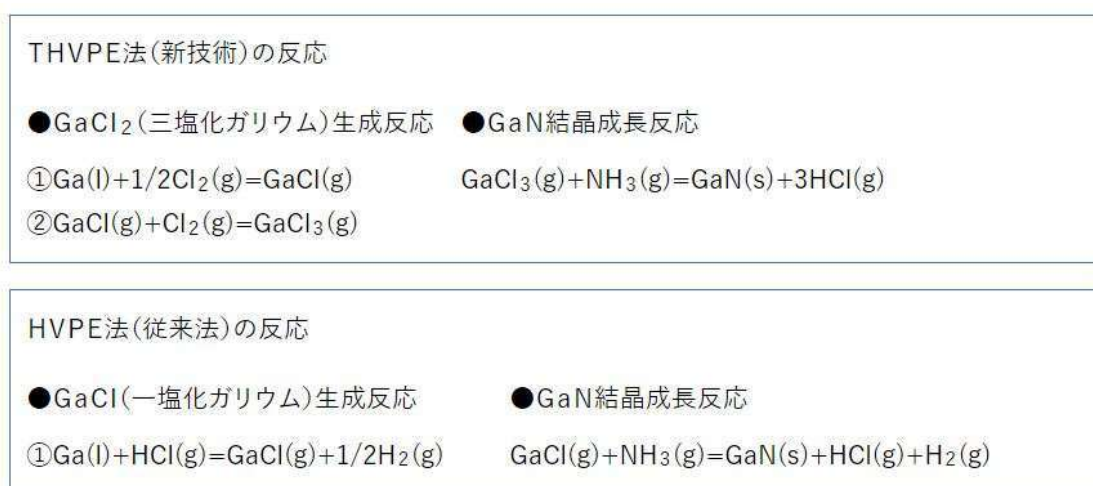
図1 THVPE法（新技術）とHVPE法（従来法）のGaN生成反応
