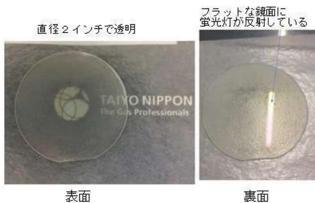
図 5 直径 2 インチの GaN 結晶例
