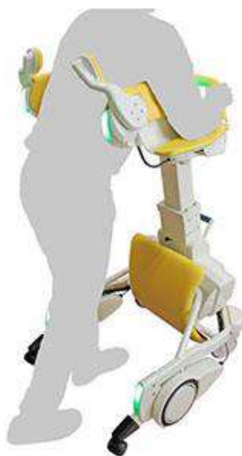
図1 転倒防止ロボット歩行車試作機 図2 使用時のイメージ
