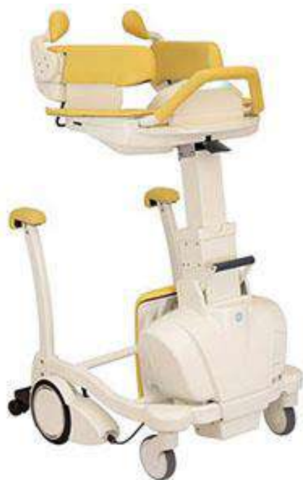
図1 転倒防止ロボット歩行車試作機 図2 使用時のイメージ
