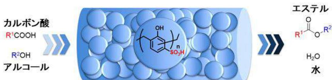
図3 第二世代型高分子酸触媒によるフロー型エステル化反応
