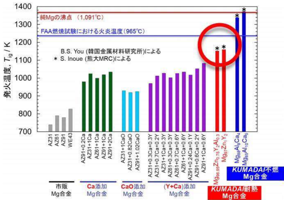
図 2. KUMADAI 耐熱マグネシウム合金と KUMADAI 不燃マグネシウム合金の発火温度の比較
