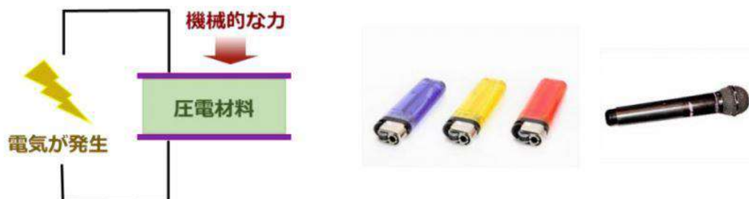
図 1. 圧電材料 (左)・圧電材料を利用した製品 (右)。
