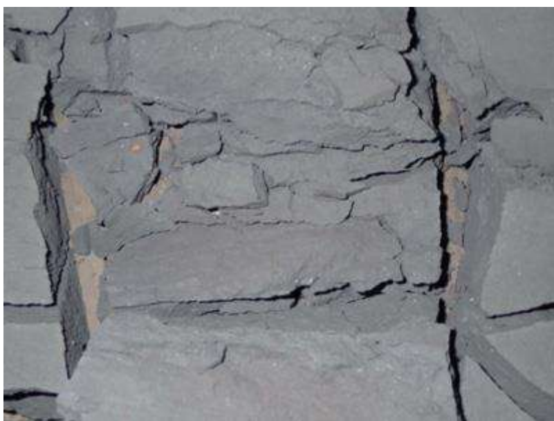
図3 製造した製鉄原料(カルシウムフェライト) カルシウム、鉄が主成分で、亜鉛、鉛、ハロゲンはほとんど含まない。
