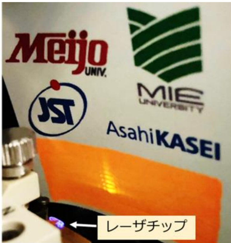
UV-Bレーザーの発振の様子 (目で見れない紫外線を目視するために紙に蛍光体を塗ってレーザー光を照射しています)
