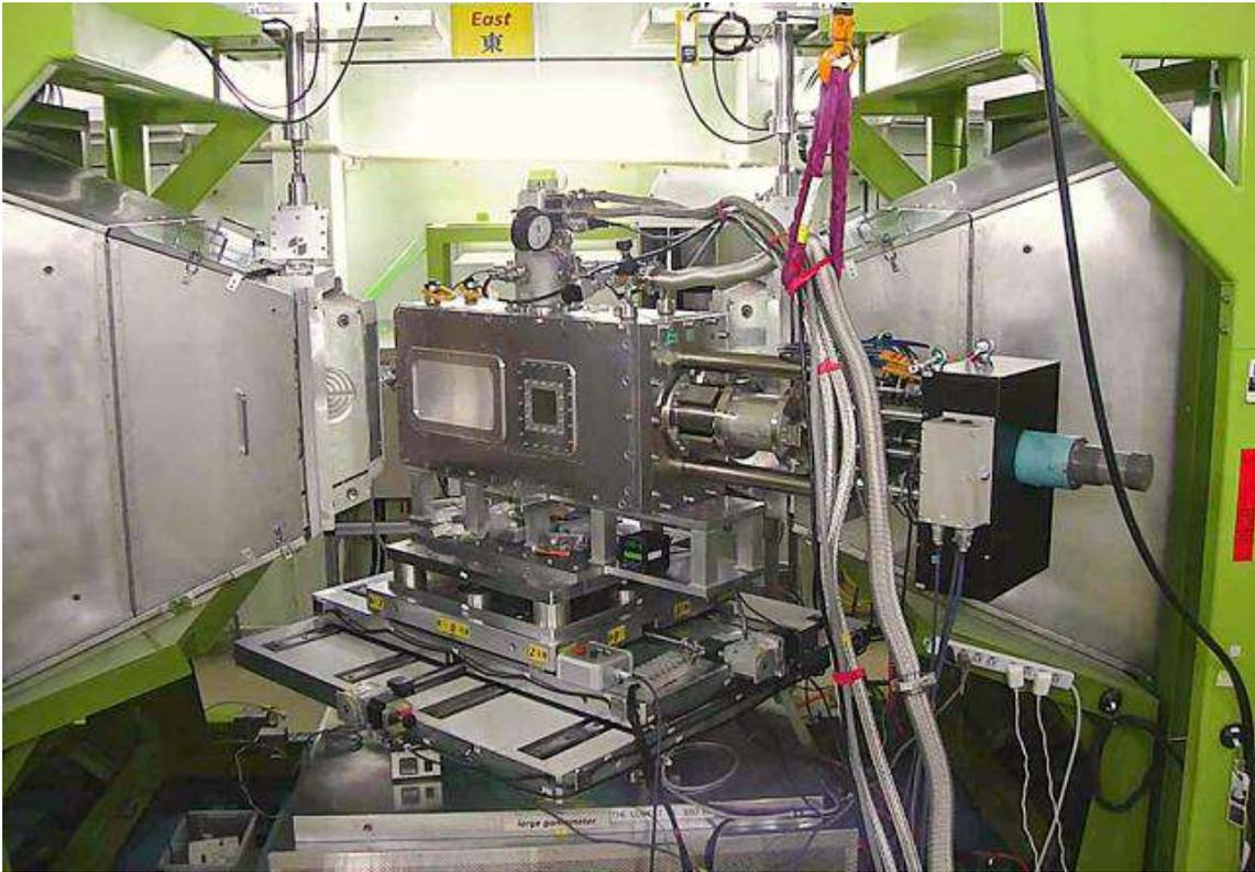
図 1. 工学材料回折装置「匠」に取り付けられた極低温引張試験機
