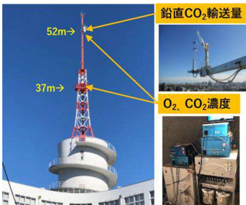
図 1 東海大学代々木キャンパス内の観測タワー（左）と用いた観測装置の一部（右）
