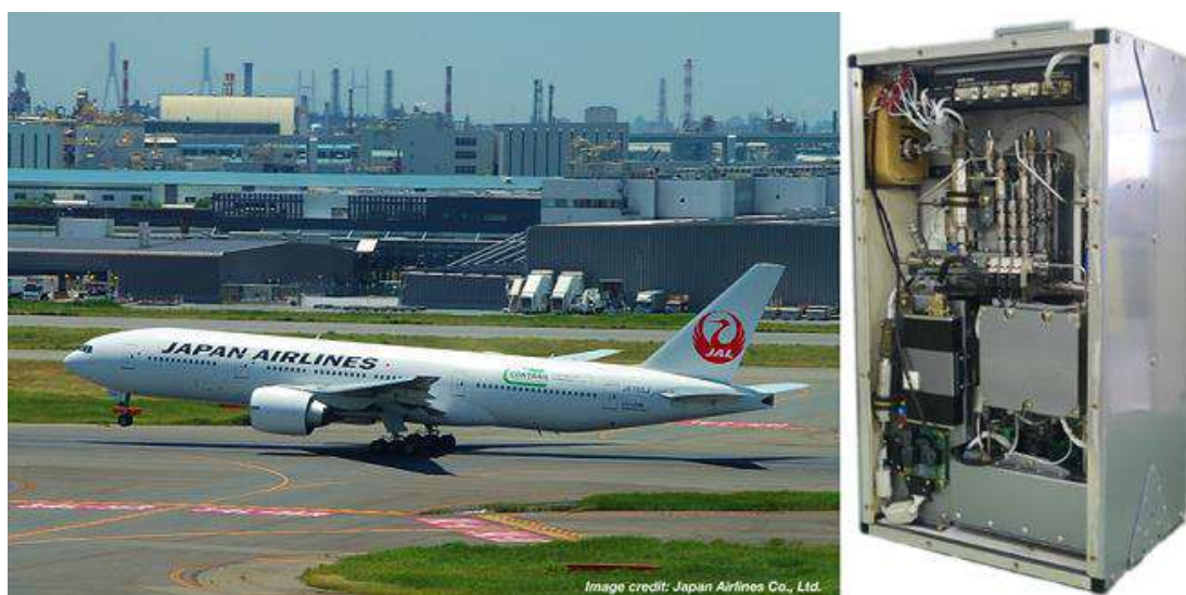
図 1. 羽田空港を離陸する日本航空の CONTRAIL ロゴ特別塗装機 (左、日本航空提供) と CO 2 濃度連続測定装置 (CME) (右)。
