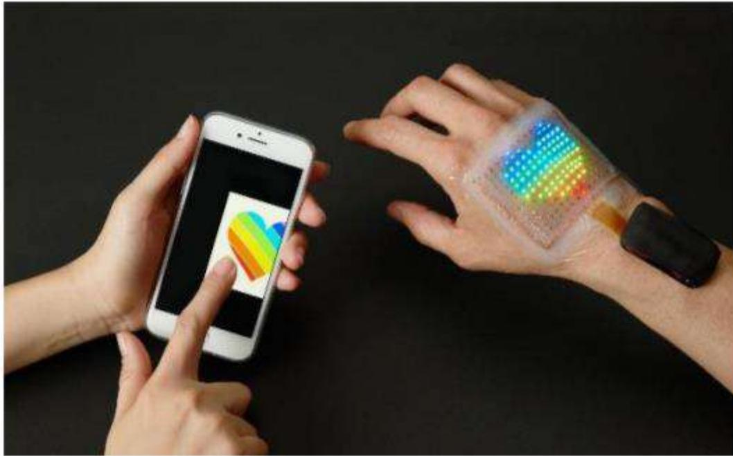
写真 2 : 表示部と、駆動回路、BLE (Bluetooth Low Energy) 通信回路、電源を一体化して皮膚に貼り付けられたフルカラスキンディスプレイ。
