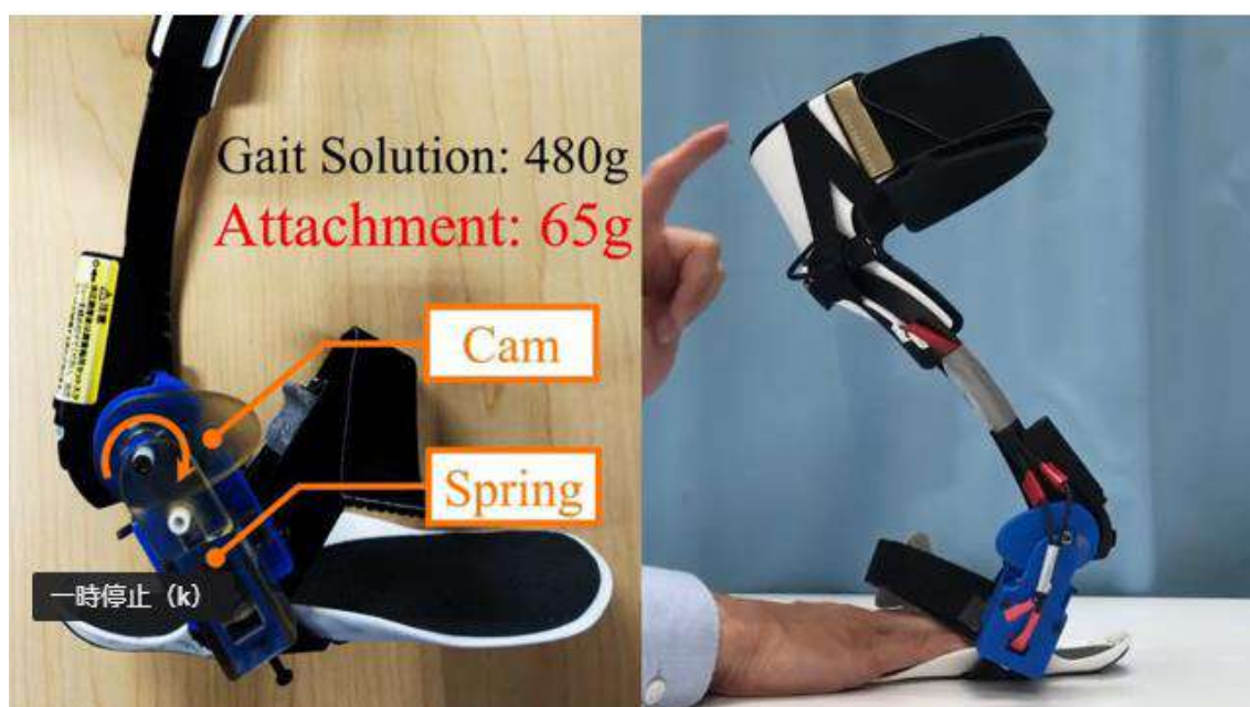
図 A： 開発したバネ-カム機構を有するデバイス（写真は右足用）。AF0 が 480g に対して、研究グループが開発したアタッチメントは 65g と超軽量かつモーターレス。中央下部に見えるネジ（地面とは非接触）で、個人の脚力に応じた調整
