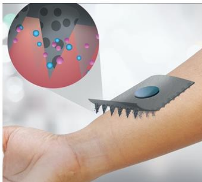
図1 多孔質マイクロニードルアレーと紙基板のパッチセンサーの概念図とその使い方
