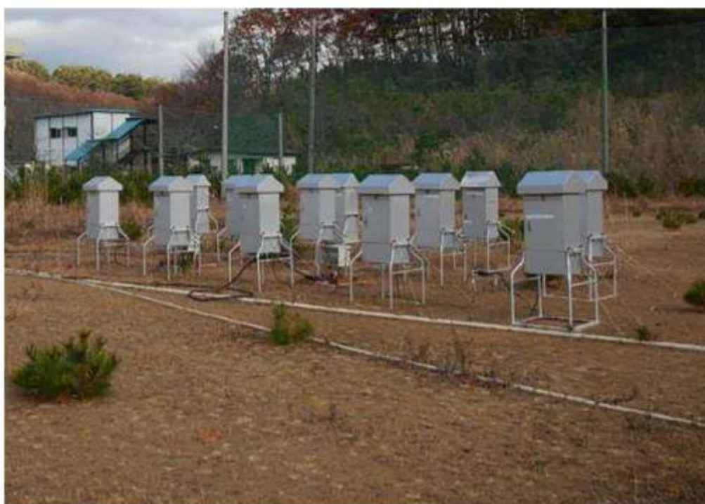
図1 福島県の帰還困難区域での大気サンプリングの様子。多数並ぶのはエアロゾル捕集用のハイボリューム（HV）サンプラー。一日当りおよそ1000立方メートルの大気を吸引する。（2016年11月撮影）
