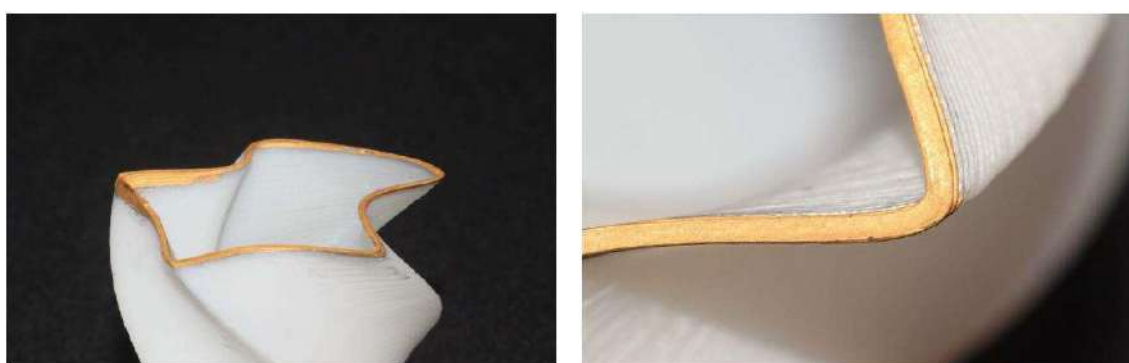
図1 プラスチックと金属から構成される立体造形物サンプル (ABS+PdCl 2 フィラメントにNiメッキを施し、さらに金メッキを施している)
