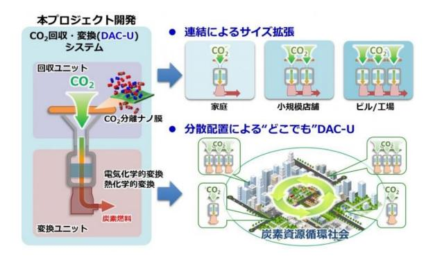
藤川准教授らが所属する九州大学の研究チームは、内閣府が主導する新しい研究プロジェクト「ムーンショット型研究開発事業」に採択され、この技術の実用化に関する研究を開始しました。このプログラムでは、場所や状況に応じて分離ユニットサイズを適応させ、大気中の CO2を直接回収し、それを有用な資源物質にオンサイトで変換することを主な開発目標としています。
