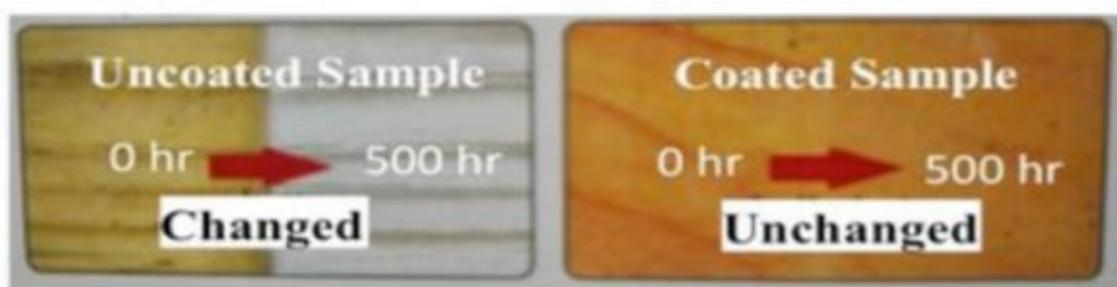
図5 超越コーティングによる木材の耐候性の変化。
