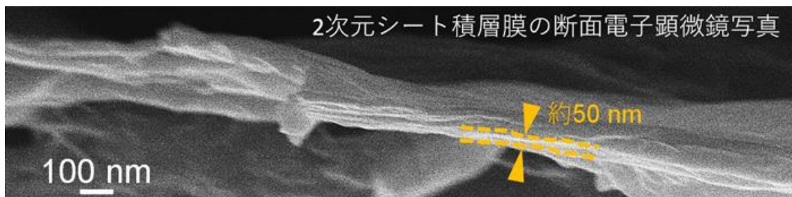
図 1 開発したナノシート積層膜の断面電子顕微鏡写真
