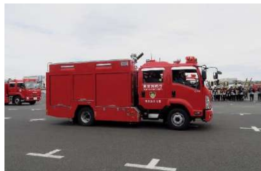
危険物火災に対応する化学消防車
