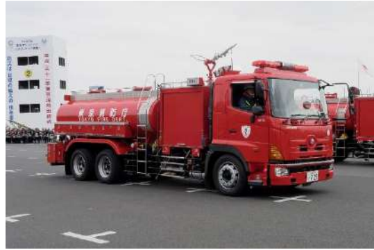
消火用水を積んだ水槽付消防ポンプ車
