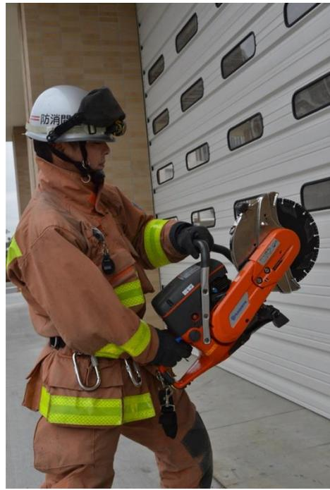
救助隊工作車に積載されているエンジンカッター、車やシャッターなど鉄板を切るための器具。
