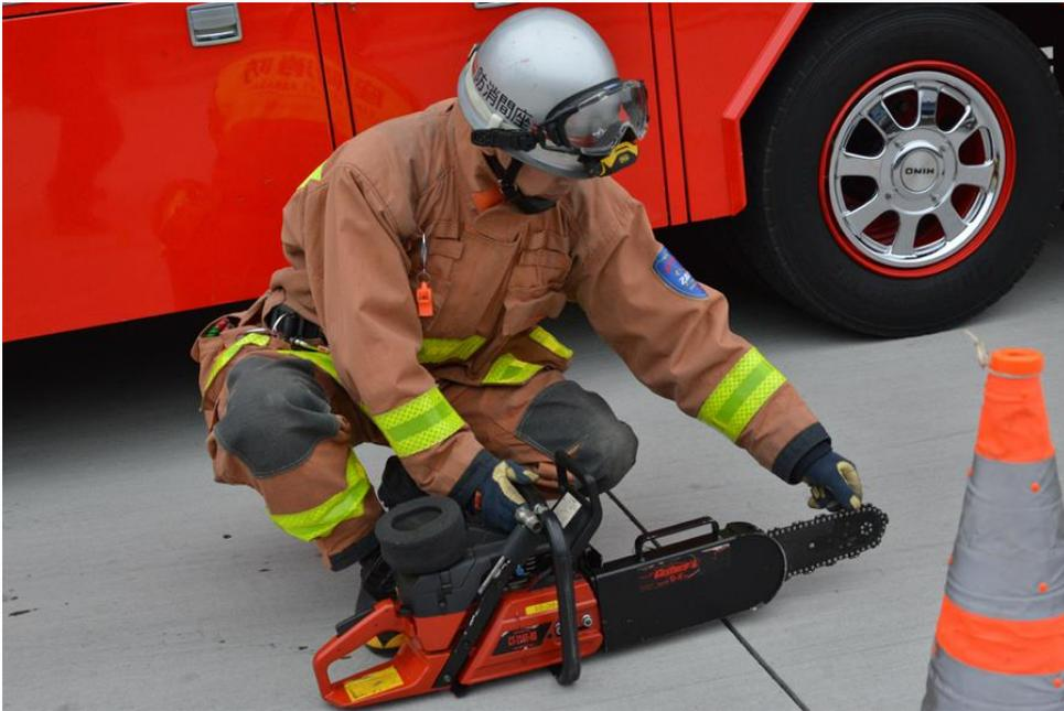
通常のチェーンソーは木を切るものだが、火災現場では都度材質を判別することが困難、鉄材が混ざっている程度なら使える仕様となっている。
